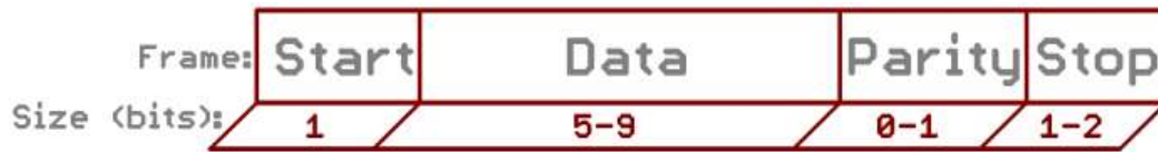
شکل ۱۱-۳ فریم سریال. برخی از نمادها دارای اندازه بیت های قابل تنظیم هستند.
