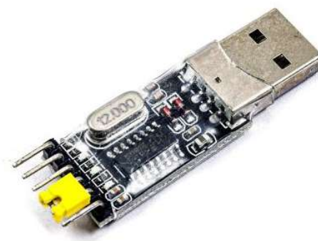
شکل ۱۱-۵ مازول مبدل USB به سریال TTL تراشه CH340G
