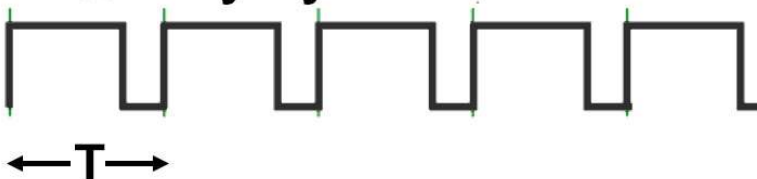
شکل ۸-۱ مفهوم Duty Cycle در مدولاسیون عرض پالس
